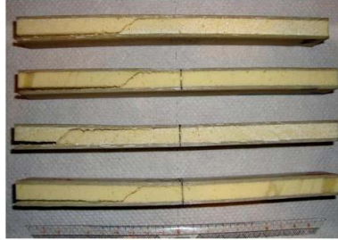
Figure II-12 : Observations macroscopique des faciès de rupture du sandwich
