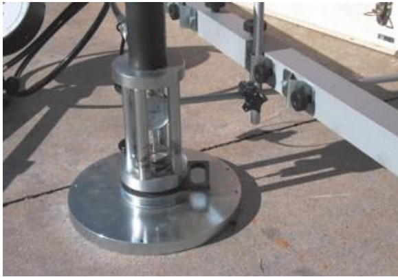
Figure 3.22: Essai à la plaque
