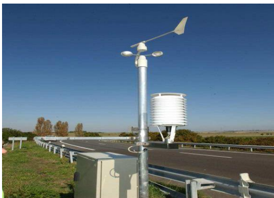
Figure 3.32: Les instruments pour suivre l'évolution des températures et déterminer l'indice de gel
