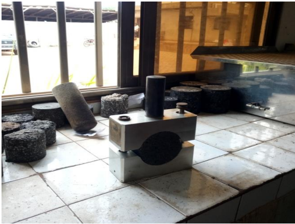
Figure 3.18: Mâchoire contenant l'éprouvette Figure 3.19: éprouvette d'enrobé
