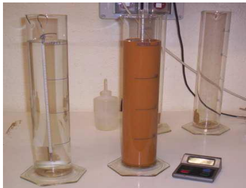
Figure 3.28: Densimètre utilisé pour l'analyse granulométrique par sédimentation
