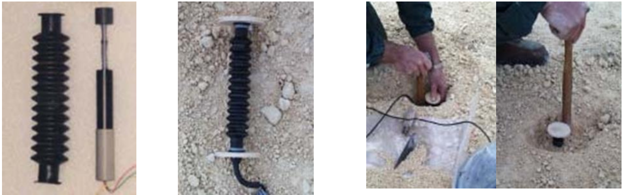
Figure 3.30: Mise en place des capteurs de température, de la fabrication jusqu'à la pose dans la couche de GNT
