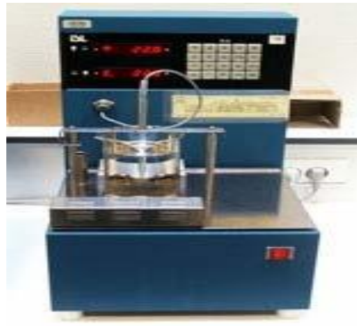
Figure 3.11 : Essai au point de ramollissement
