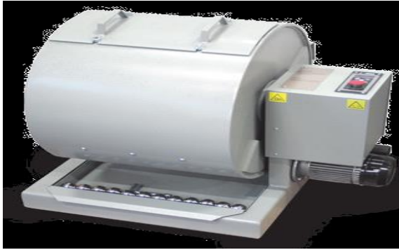
Figure 3.24: essai de la résistance à la Fragmentation
