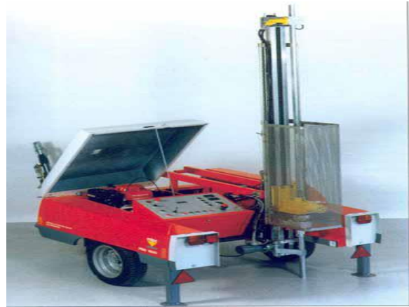
Figure 3.21: Essai au Pénétrömètre dynamique
