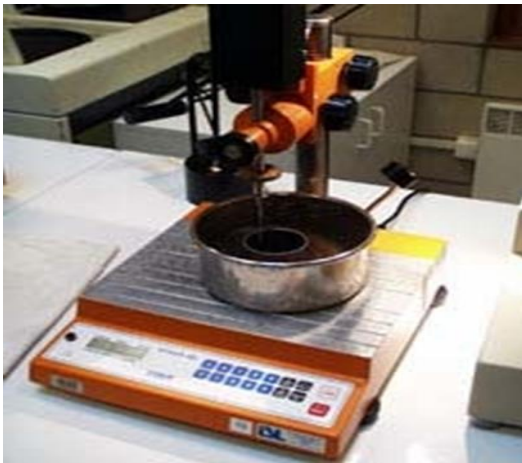
Figure 3.10: Essai de pénétrabilité
