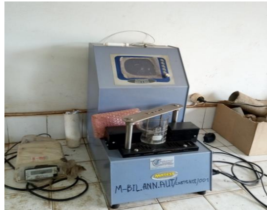
Figure 3.13: Essai au pénétromètre
