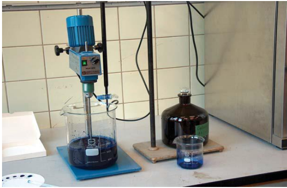
Figure 3.26: Appareillage pour essai au bleu de méthylène
