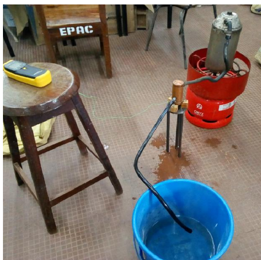
Figure 2.11 : Montage du dispositif expérimental du disque de Lee
