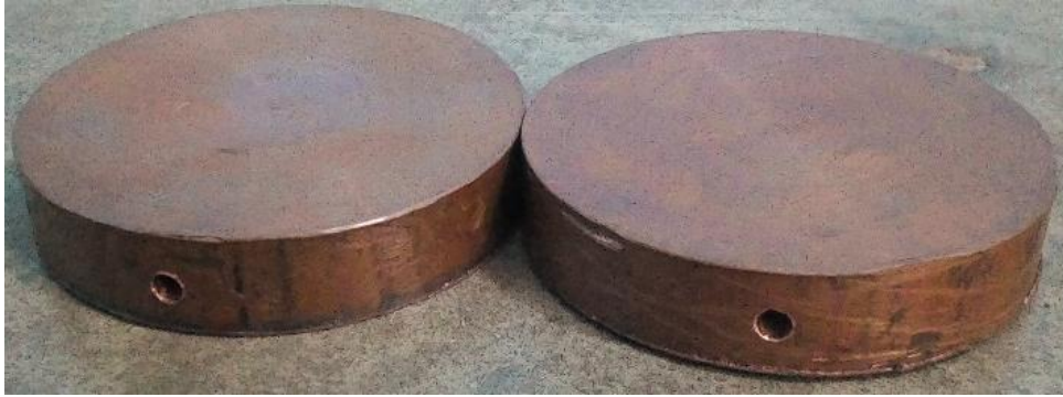
Figure 2.2 : Disque en Cuivre de diamètre 50 mm et d'épaisseur 10 mm
