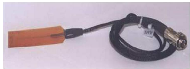
Figure 1.10 b : Vue d'une sonde de type fil chaud [8]
