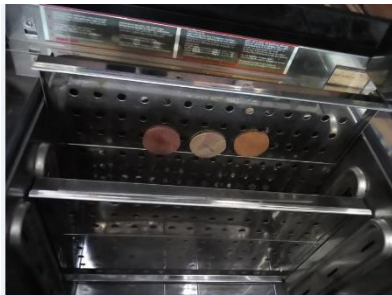
Figure 2.13a : Echantillons à tester à l'étuve
