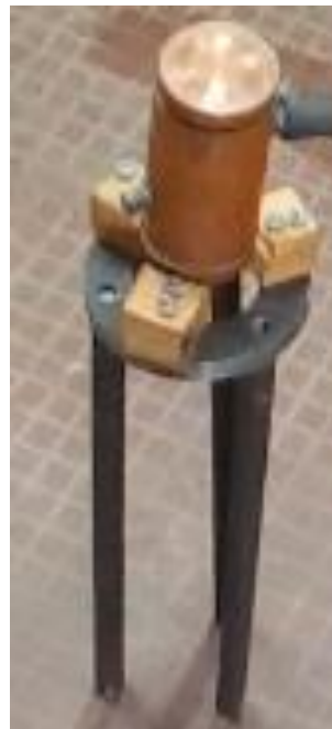
Figure 2.8 : Support de l'ensemble disques en cuivre-échantillon -chambre à vapeur
