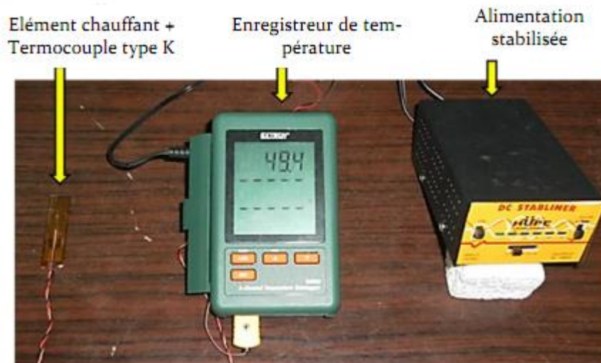
Figure 2.17 : Dispositif expérimental du chaud
