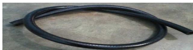
Figure 2.9 : Tuyau PVC de canalisation de la vapeur
