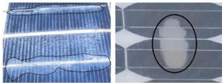
Figure 14: Module photovoltaïque présentant une delamination
