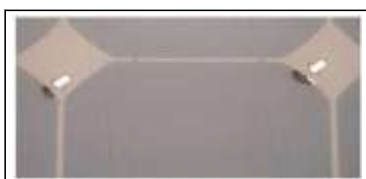
Figure 16: Modules présentant des points chauds sur les bords des coins supérieurs.
