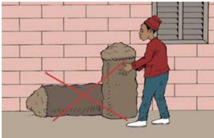
Photo 6: Sacs chargés disposés contre un mur en ML
