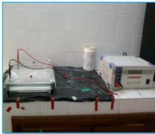
Photo 3: Dispositif de migration du produit PCR (CREC 2012)
