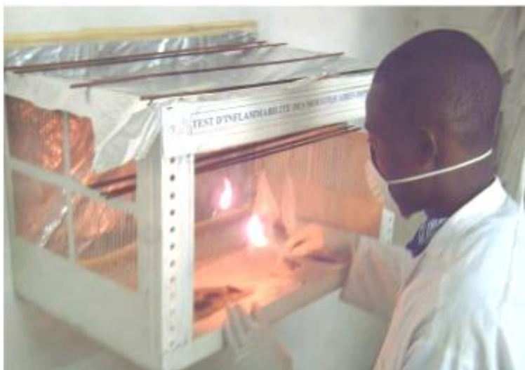
Figure 9 : Inflammabilité d'un fragment de moustiquaire (Azondekon; 2007)
