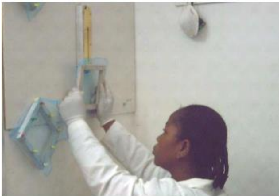
Figure 7: Mesure de la force de déchirement (Azondekon; 2007)
