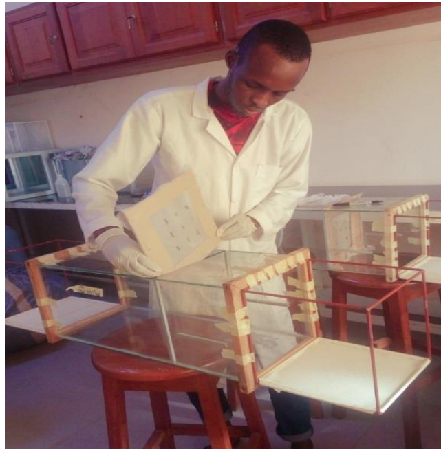
Figure 5: Mise en place de la moustiquaire pour le test en tunnel Source : Thoni Boris SOSSOUKPO 2018
