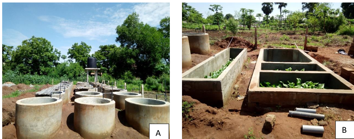
Figure 2: Dispositif expérimental. A : Bassins expérimentaux ; B : Filtres biologiques.
