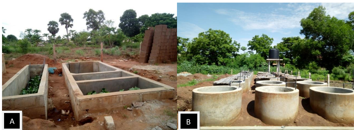
Figure 3 : Dispositif expérimental (A : filtre biologique ; B : bassins expérimentaux)
