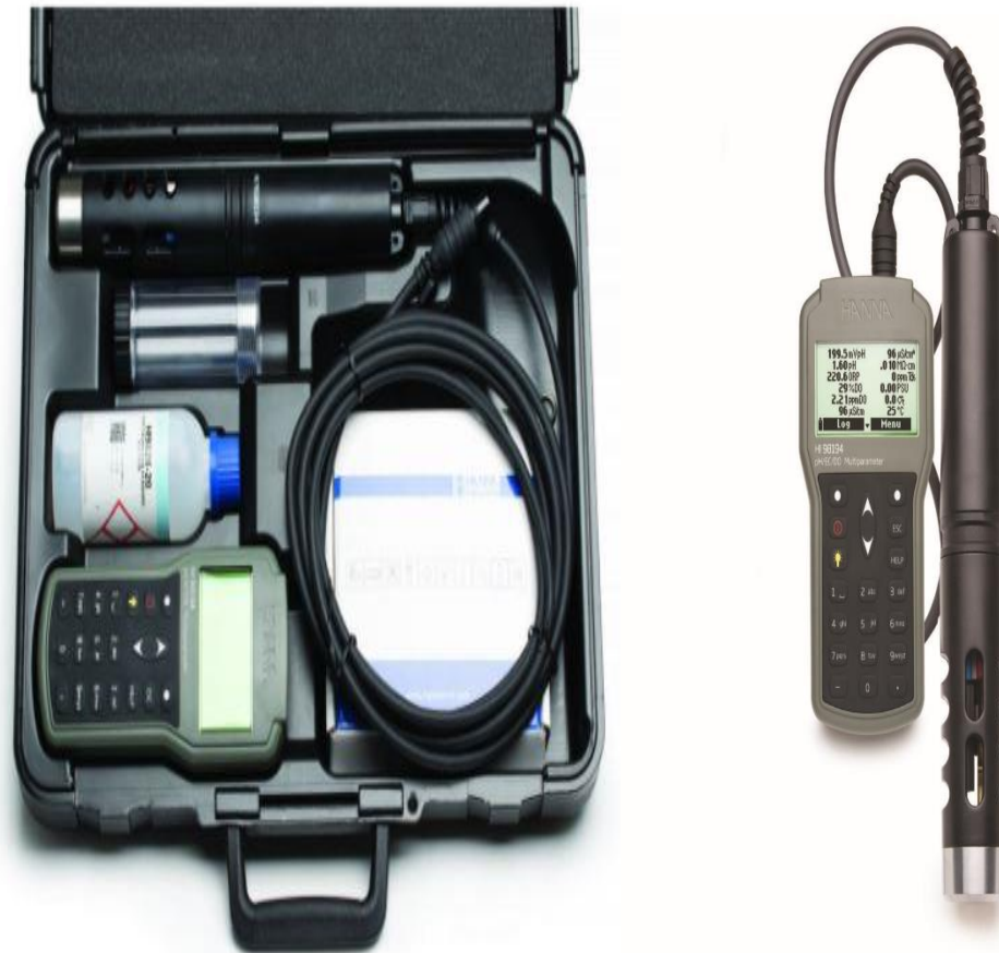
Figure 2.11: Compartiment intérieur de la mallette du kit multiparamètres
