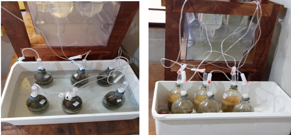
Figure 2.10: Photos du dispositif expérimental mis en place pour la production du biogaz
