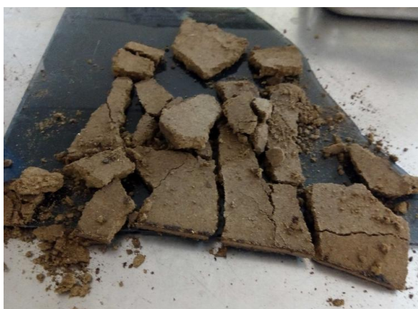
Figure 2. 14: Echantillon avec 25% d'eau et 15% d'amidon
