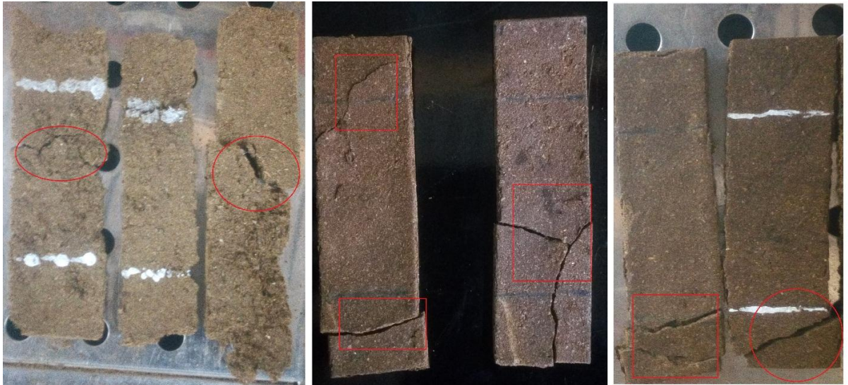
Figure 3. 9: Mode de rupture des agro-matériaux
