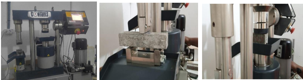
Figure 5-8 : Machine de type Controls pour les essais de flexion et de compression
