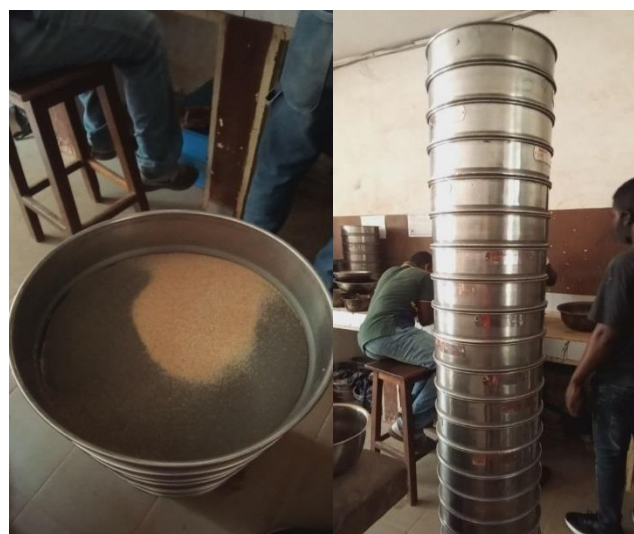
Figure 5-1 : Série normalisée de tamis AFNOR
