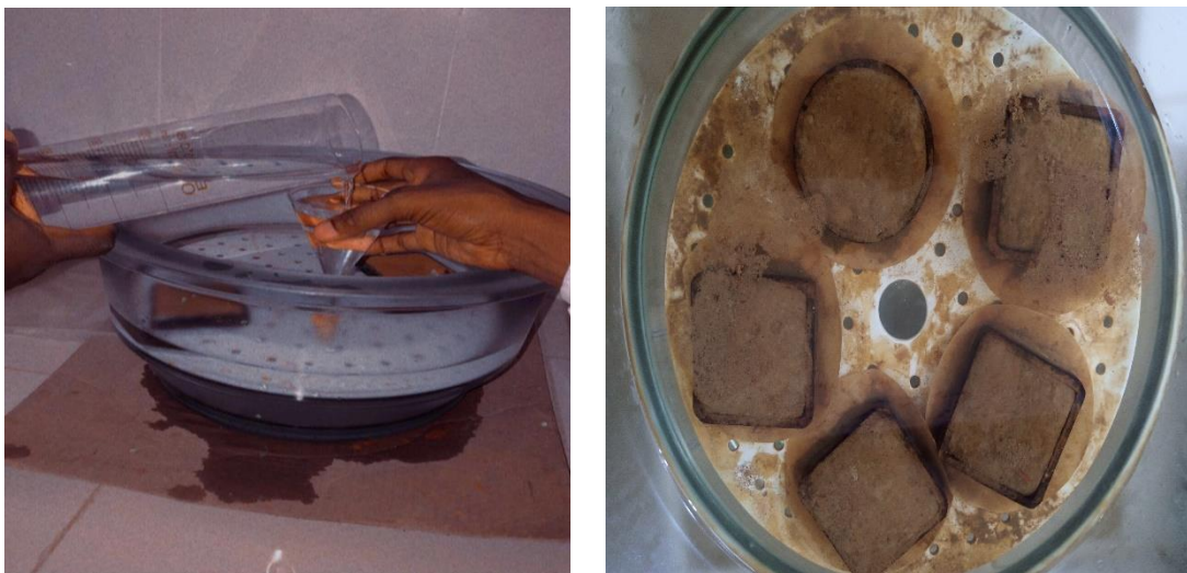
Photo 2.3 : Appareillage pour l'humidification
