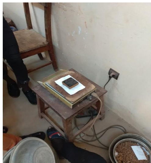
Photo 2.2 : Appareillage de dessiccation : étuve et pesée
