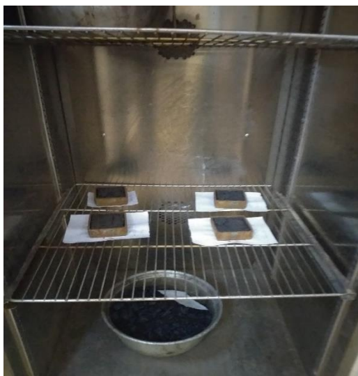
Photo 2.2 : Appareillage de dessiccation : étuve et pesée
