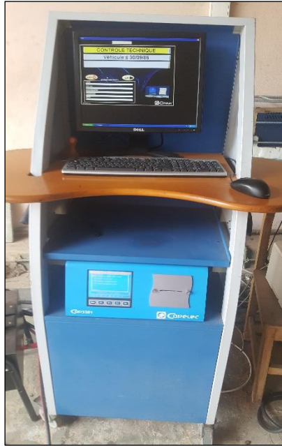
Figure 12 : Analyseur Multigaz fixe connecté à un ordinateur (Source : Gath, 2019)
