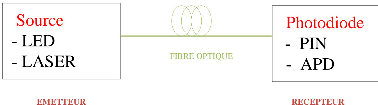
Figure 1.2 : Schéma d'une liaison optique à modulation directe:
