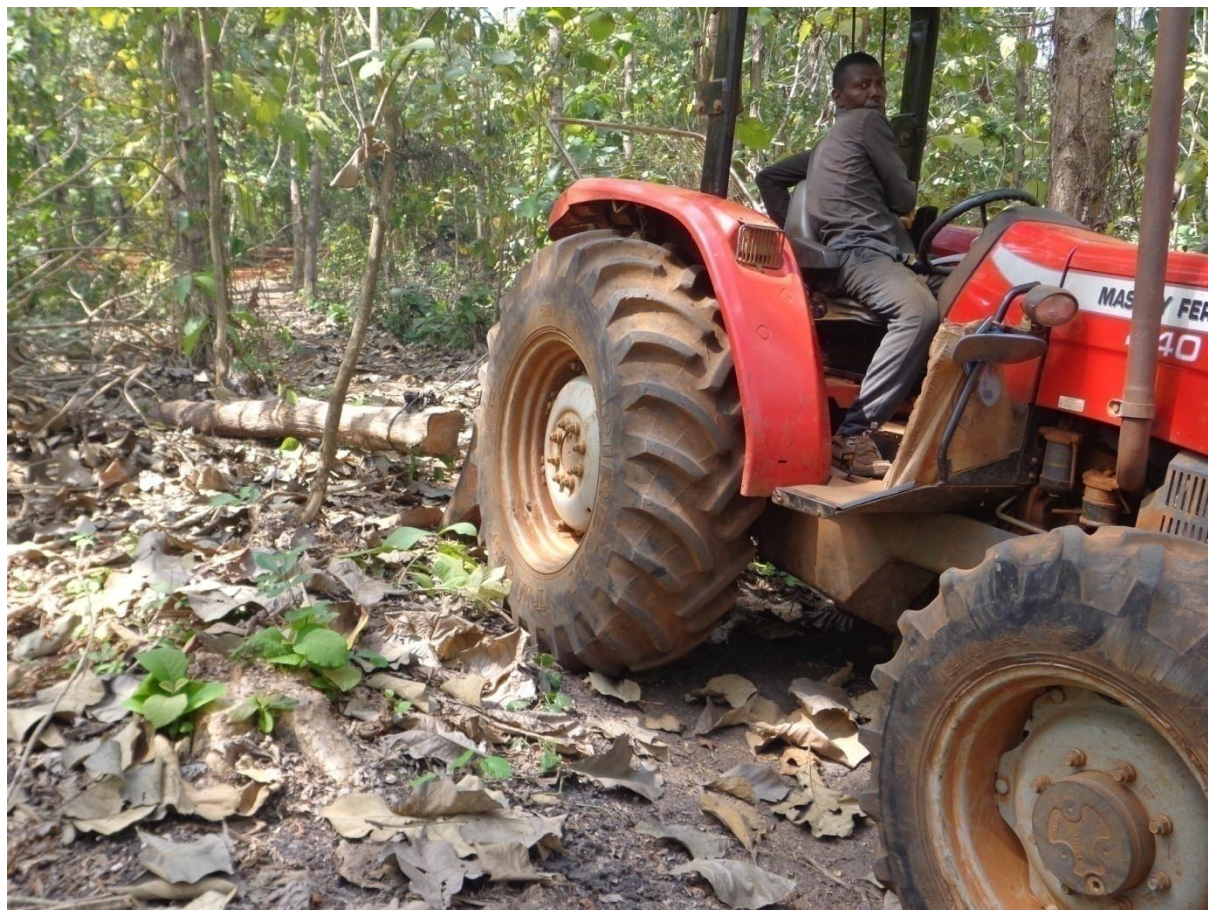
Photo 15: Un tracteur MF 440 en cours (maintenu sur la piste) de débardage dans le cadre de l'EFI
