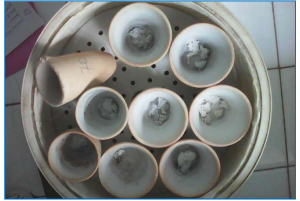
Photo 8 : Obtention de cendre après calcination
