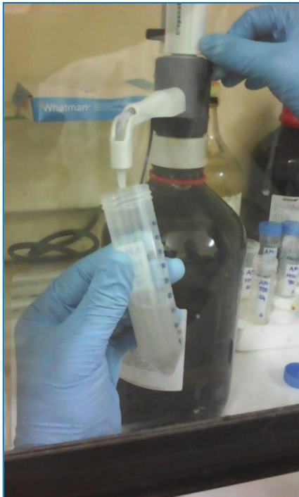
Photo 9 : Ajout d' \text{HNO}_3 à la cendre
