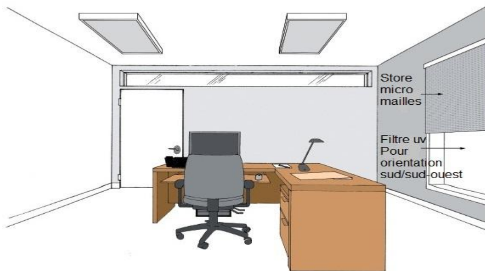
Figure 13 : L'ambiance lumineuse d'un poste de travail informatisé
