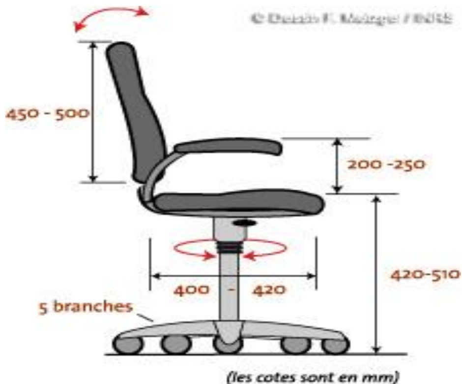
Figure 14 : Un fauteuil ergonomique conforme à la norme NF EN 1335-1 Source : INRS (2004)
