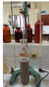
Figure 5.2: Bille de verre (a) et tamis utilisé (b) Pipette de Robinson avec allonge pour le prélèvement de FOM (c)
