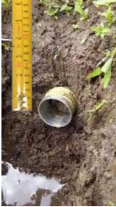
Figure 5.1: Prélèvement du sol avec le cylindre densité
