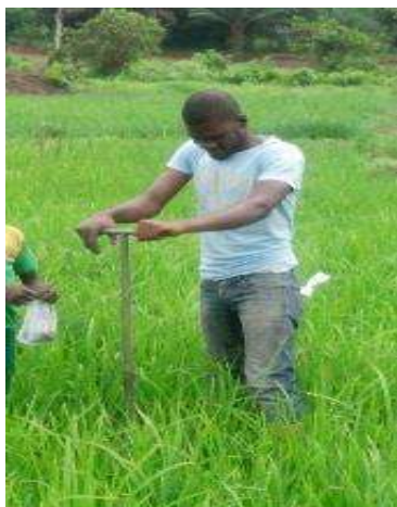
Figure 7.1: Prélèvement d'échantillons de sol à la tarière
