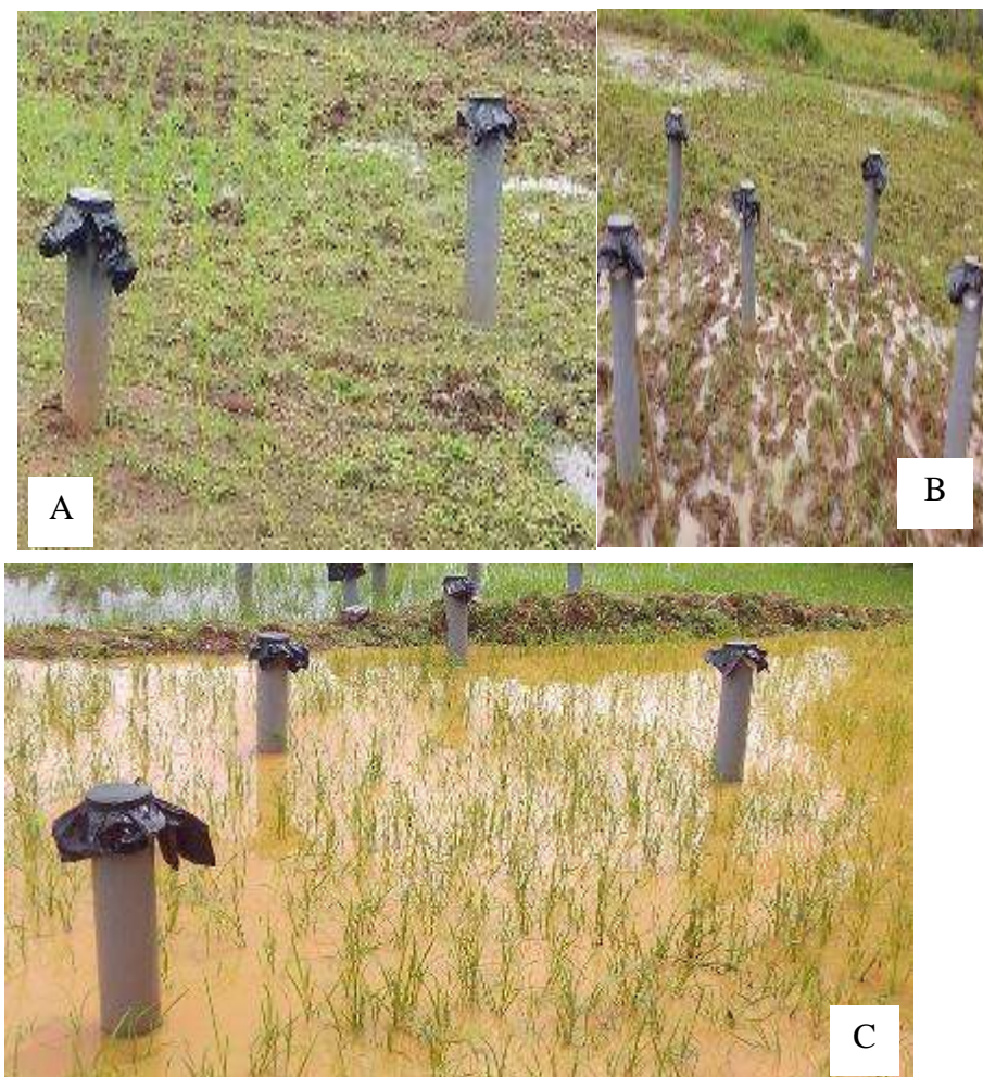
Figure 5.5: Dispositif de captage du CO 2 dégagé; A: Traitement T1; B : Traitement T2; C : Traitement T3
