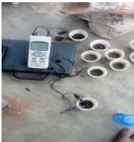
Figure 7.2: pH-mètre utilisé pour la mesure in situ
