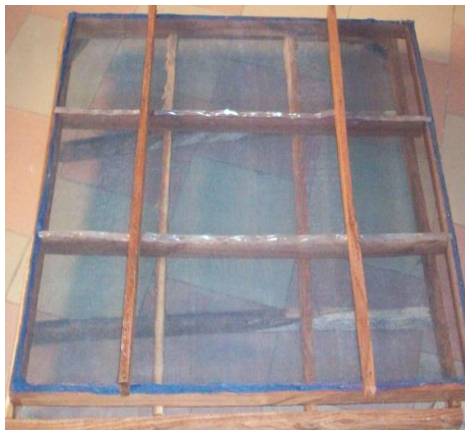
Figure 3. 7: Dispositif de séchage
