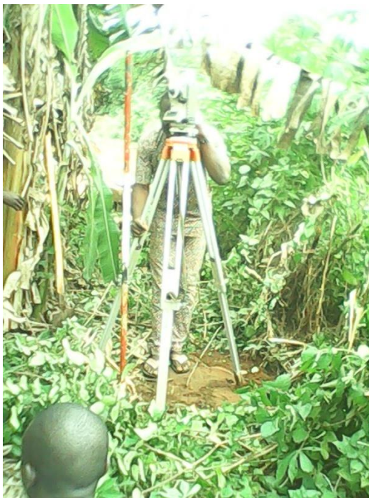
Photo n°1 : une opération d'implantation de bornes dans le lot 371, cliché : GUIYOH (août 2014)
