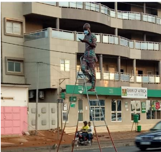
Photo 3.3 : Mesure de l'intensité sonore du bruit routier au carrefour IITA.
