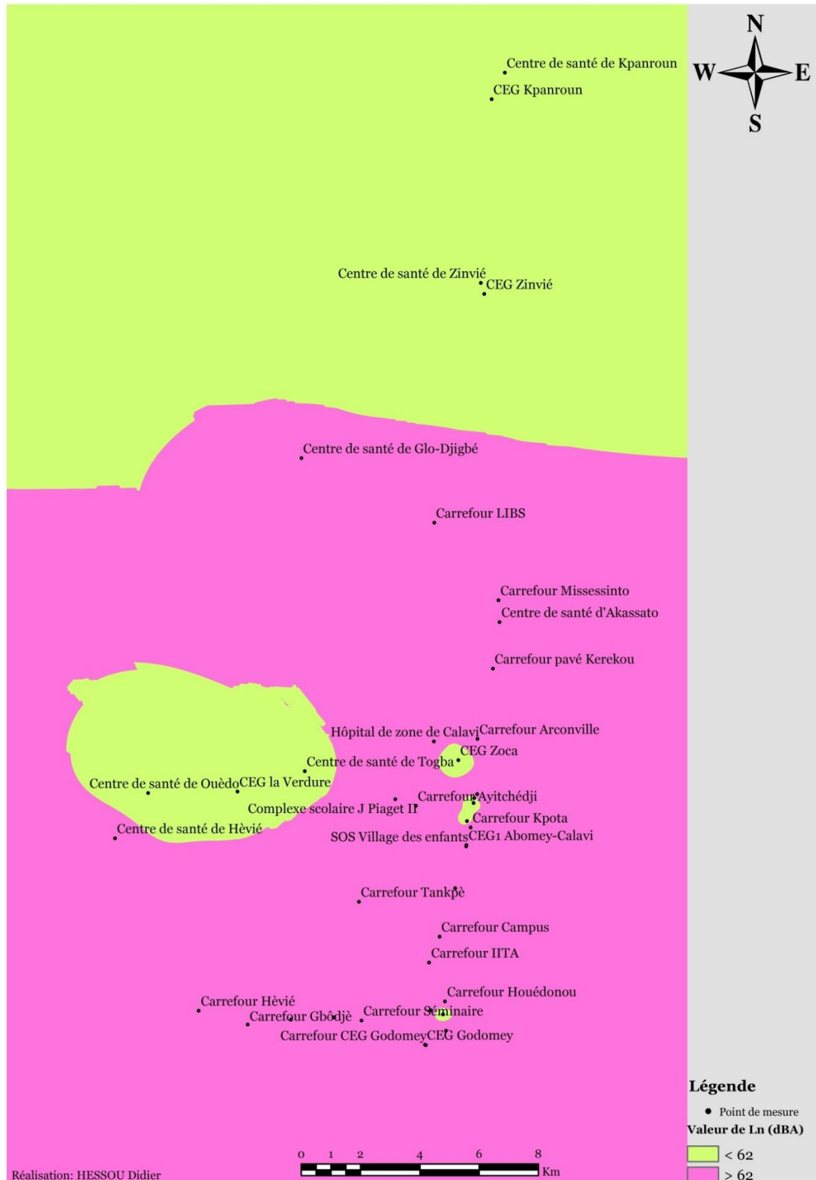
Figure 4.9 : Cartographie des variations spatiales des niveaux de bruit limites dans la commune d'Abomey-Calavi pour la période de nuit .
