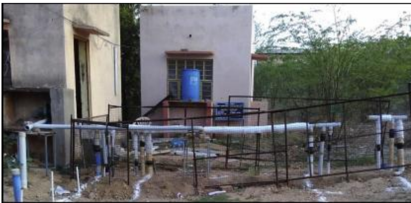
Figure 11 : Montage expérimental de systèmes d'échangeur air sol secs et humide [11]
