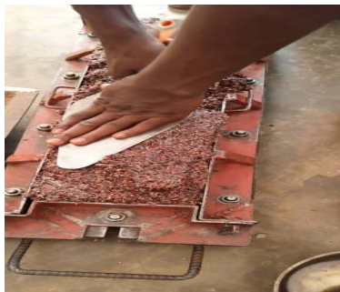
Photo 2-16 : Moule rempli du mélange gosses de mil-polystyrène
