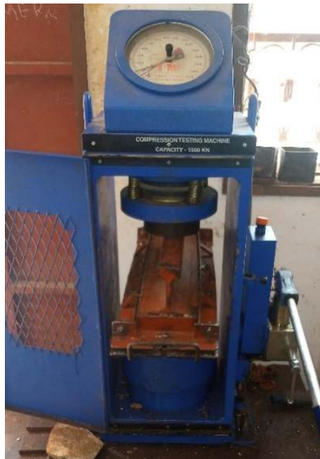
Photo 2-18 : Presse mécanique pour le compactage du mélange
