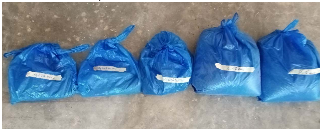
Photo 2-8 : Séparation des grains de balles de riz par classes granulaires
