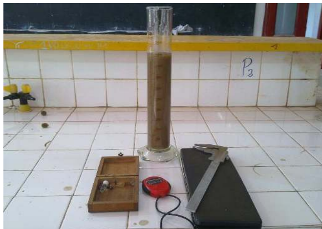
Photo 2-7 : Essai de viscosité sur la colle
