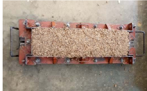
Photo 2-17 : Moule rempli du mélange balles de riz-polystyrène
