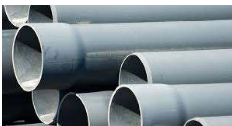
Photo 1-9:Tuyaux en Polychlorure de vinyle
