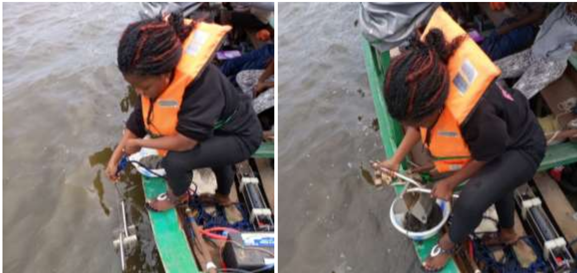
Planche 1: Prélèvement des sédiments du fond lagunaire avec la benne de Eckman (Viainon, 2022)
