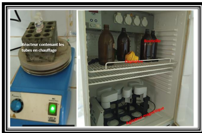
Planche 3-4 : Processus en cours de détermination de DCO (à gauche) et Matériel de DBO5 (à droite) (Photos prises par Zabene, 2023).
