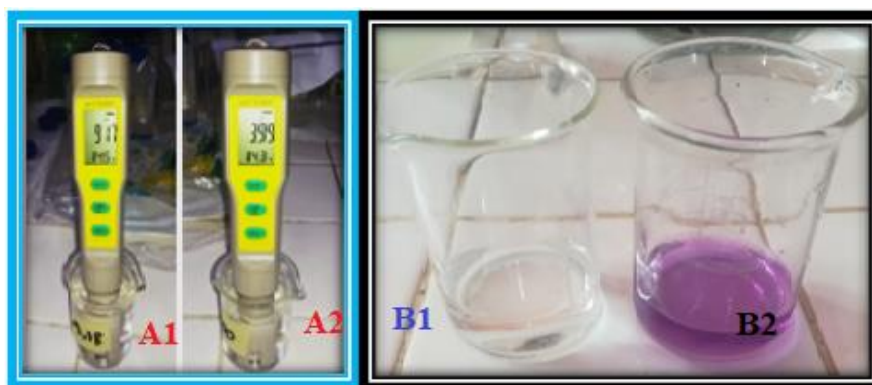
Planche 3-3 : Valeurs obtenues lors de l'une des séances du calibrage du pH-mètre (A1 : pH 9,18 ; A2 : pH 4,00) et la coloration de la solution à l'ajout du cuVer1 (B1 : avant et B2 : après ajout) (Photos tirées par Zabene, 2023)
