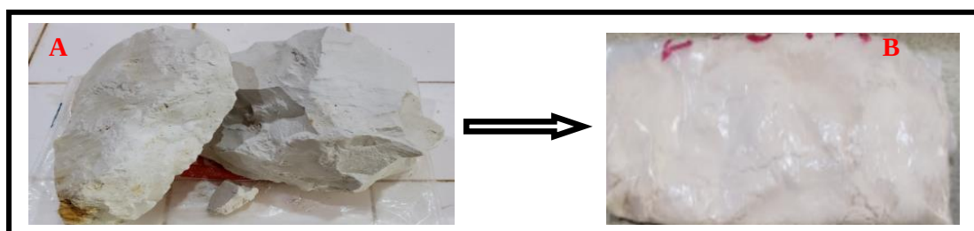
Planche 3-2 : Transformation de l'argile : Argile brute (A) et géopolymère élaboré (B) (Dazogbo, 2022)
